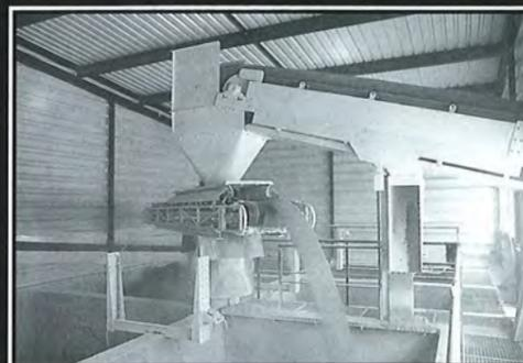
Reversier- und schwenkbares Förderband zur Beschickung der Zuschlagstoff-Boxen
